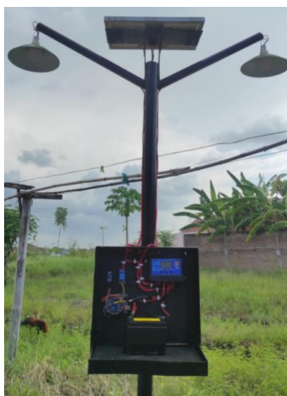
Gambar 5. Alat sistem kontrol pencegah hama bawang merah
