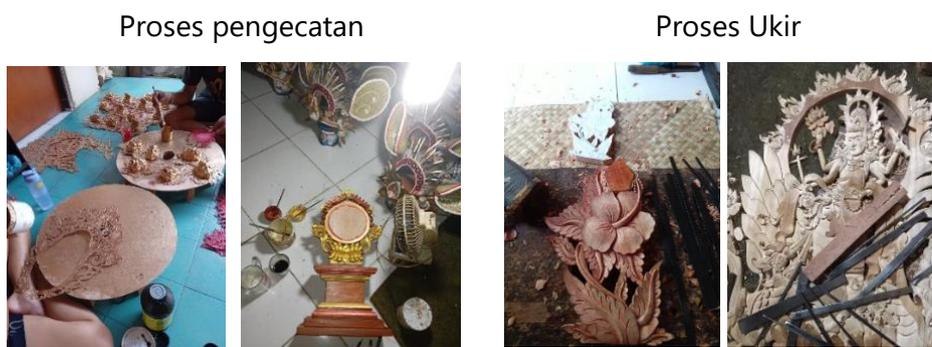
Gambar. 4 Proses Manual Pengecatan dan Ukir
